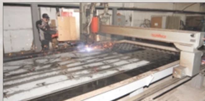
Вальцы и машина плазменной резки «Техмаш» – все работает с полной нагрузкой
