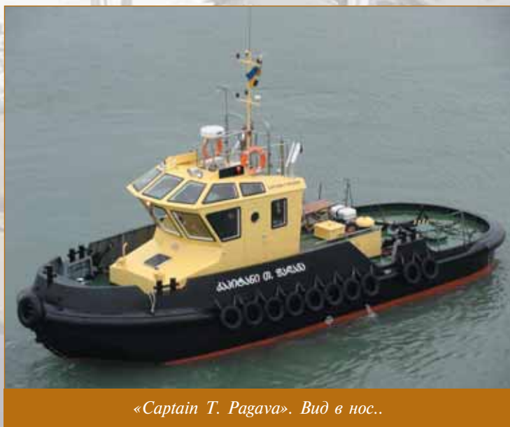
Форма рубки буксира гарантирует отличный обзор
