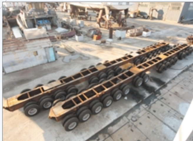
Стапель и стапельный поезд емл 400 тонн
