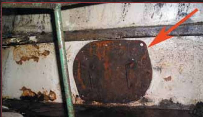
Закрытый в период аварийно-спасательной операции лаз в сухой отсек левого борта з/с «Черное море»
