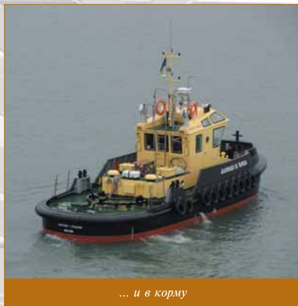
Форма рубки буксира гарантирует отличный обзор
