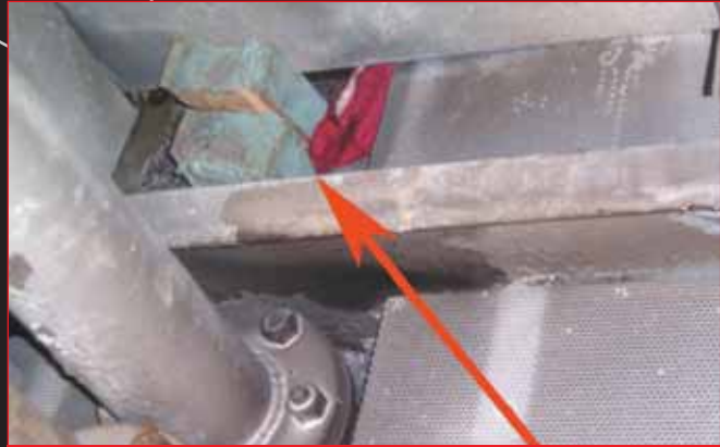
Чоп, закрывающий отверстие в переборке 64 шп. между машинным отделением и сухим отсеком правого борта
