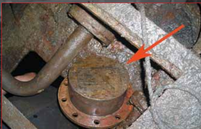
Вибратор эхолота з/с «Черное море» — основная причина аварии
