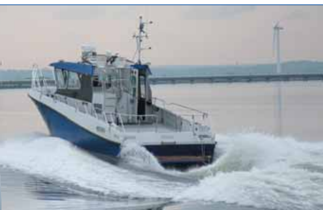
Рабочий катер «Volvo Penta-60» оснащен двумя пропульсивными комплексами IPS600
