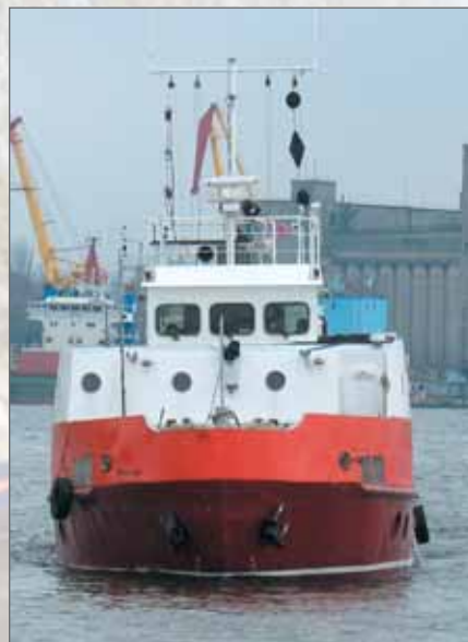
Отличительная черта модернизированного судна – надстройка на всю ширину корпуса
