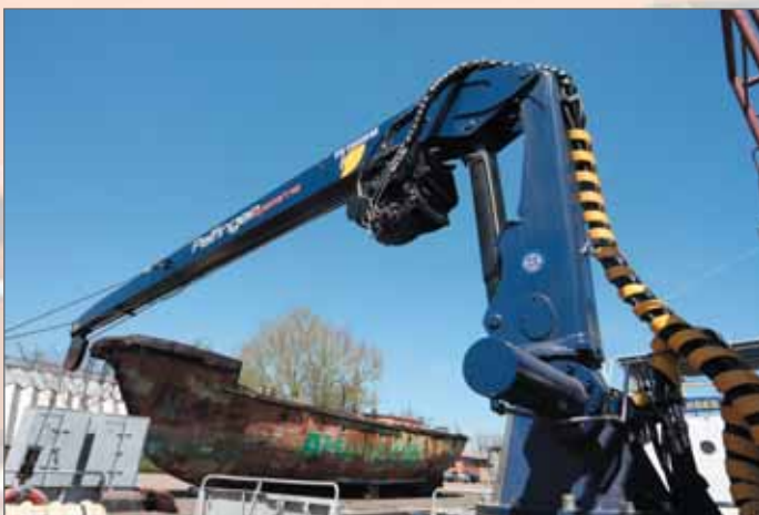
Гидравлический 2,3-тонный кран Palfinger PS15500M
