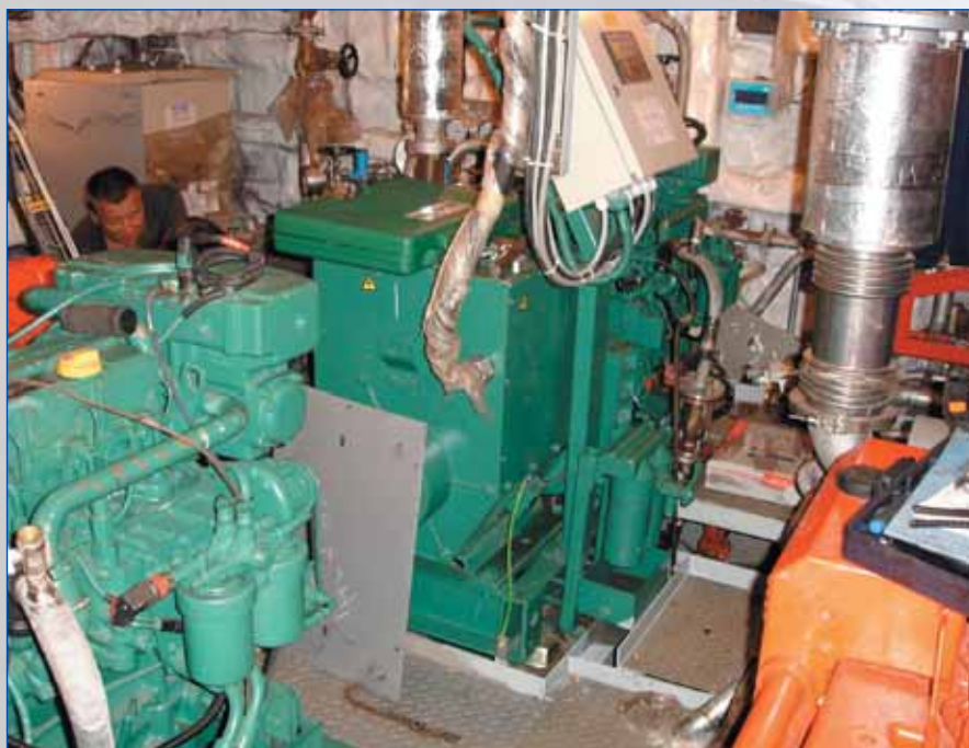
Дизель-генератор в МО буксира пр.ТГ04
