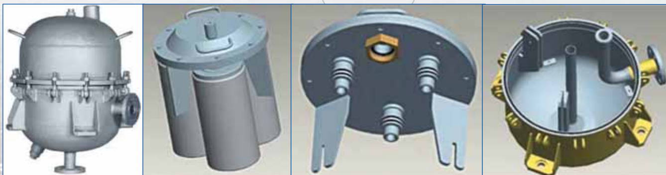
Устройство фильтра тонкой очистки-сепаратора топлива ФСТ 40/10 с фильтрующими элементами статического типа
