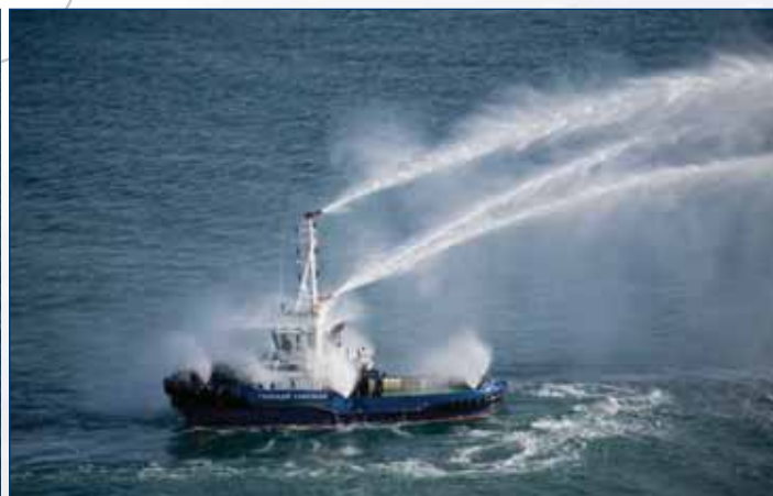
Суммарная производительность двух пожарных мониторов и системы водяной завесы — 2600 м³/ч
