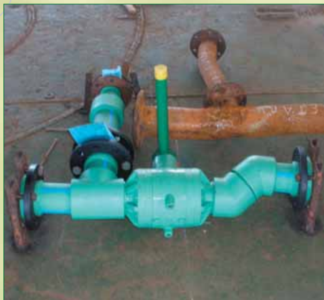
Пришедшие в негодность трубопроводы круизного судна «Марина Цветаева» «Гольфстрим» заменил на пластмассовые системы
