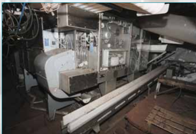
Рыборазделочная машина фирмы Baader
