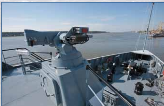
12,7 мм пулеметная установка Oto Melara с дистанционным управлением
