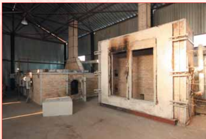
Печи для проведения огневых испытаний горизонтальных (слева) и вертикальных (справа) судовых конструкций
