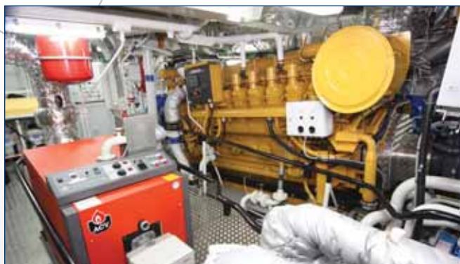
В МО своих буксиров Damen устанавливает дизели Caterpillar
