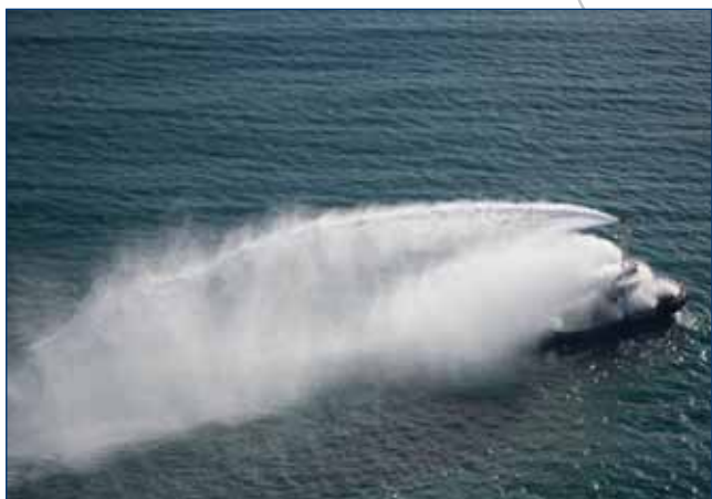
Суммарная производительность двух пожарных мониторов и системы водяной завесы — 2600 м³/ч
