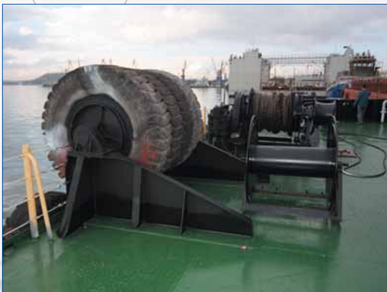
Один из четырех барабанных кранцев перегрузочного комплекса
