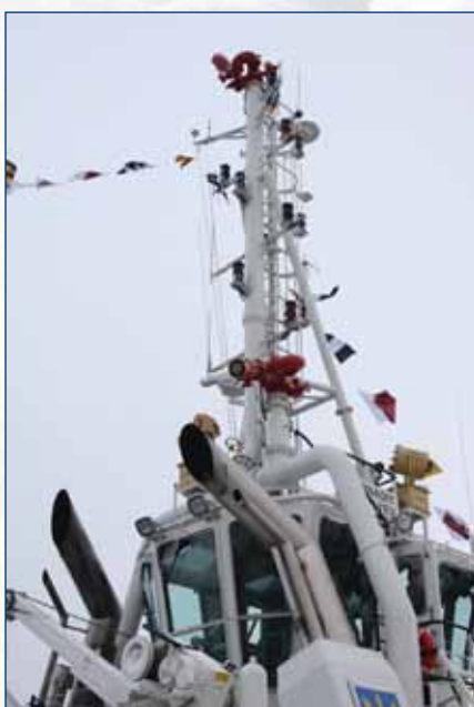
Отличительная черта каждого из двух буксиров для порта «Южный» — установленный на клотике мачты монитор, гарантирующий тушение возгораний на высокобортовых судах
