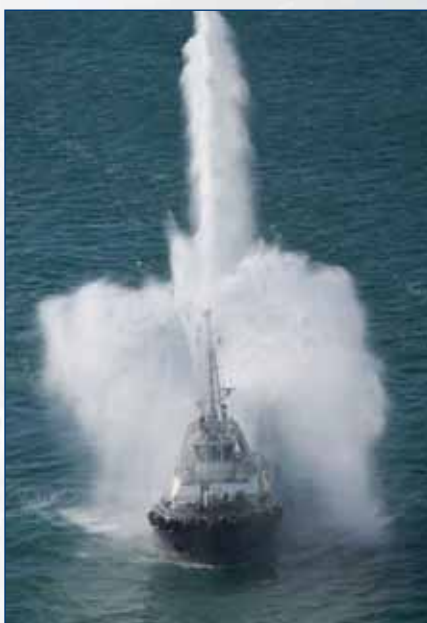
Суммарная производительность двух пожарных мониторов и системы водяной завесы — 2600 м³/ч
