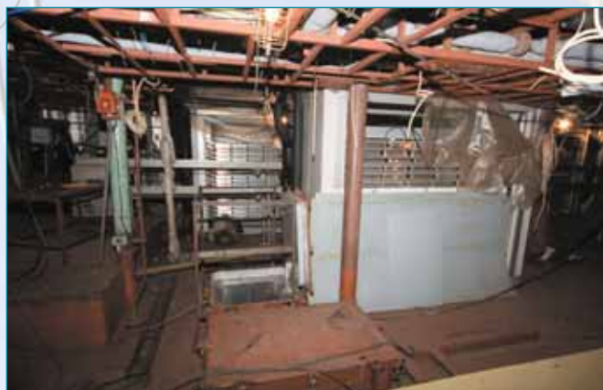
Аппараты глазировки рыбной продукции фирмы Rosoma
