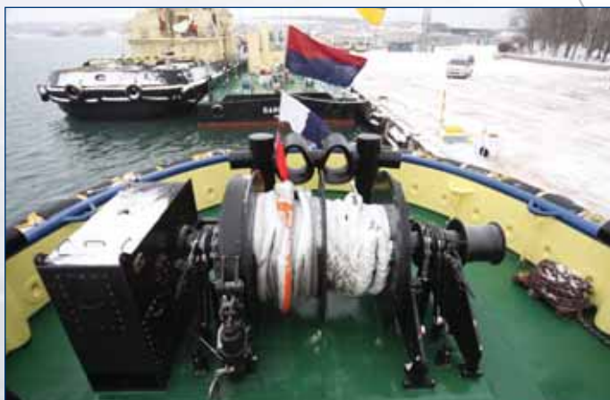
Носовая буксирно-якорная лебедка буксира «Геннадий Савельев» и его кормовой буксирный комплекс: гак, лебедка, битенг и клюз
