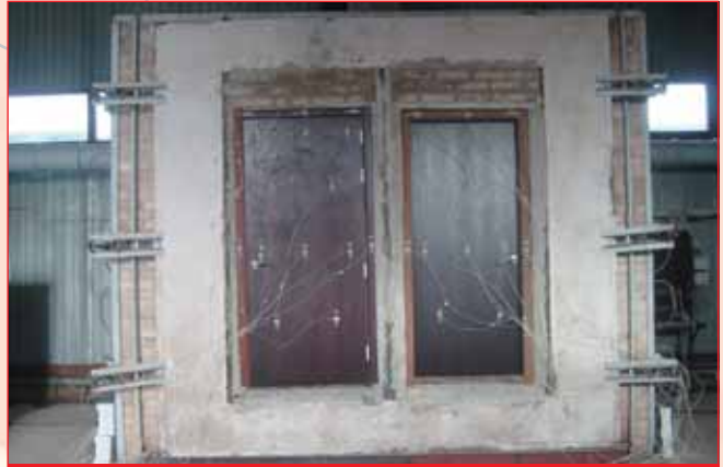
Противопожарные двери подготовлены к огневым испытаниям
