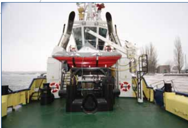
Носовая буксирно-якорная лебедка буксира «Геннадий Савельев» и его кормовой буксирный комплекс: гак, лебедка, битенг и клюз
