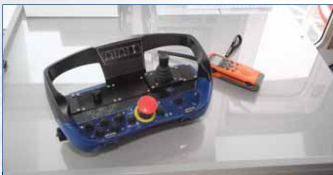
Переносной пульт управления носовой буксирно-якорной лебедкой
