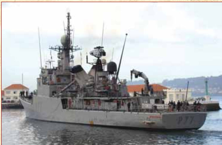
В носовой части патрульных кораблей на базе «Descubierta» осталось только 76-мм орудие OTO Melara, сохранились ПКР Harpoon, а в корме снято все вооружение
