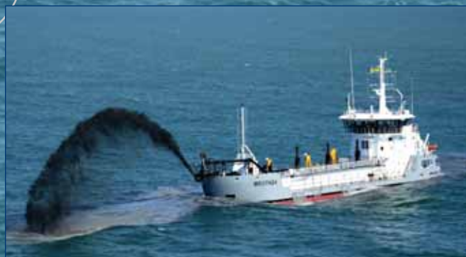
Струйная разгрузка земснаряда «Меотида»
