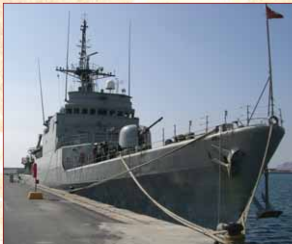
В носовой части патрульных кораблей на базе «Descubierta» осталось только 76-мм орудие OTO Melara, сохранились ПКР Harpoon, а в корме снято все вооружение
