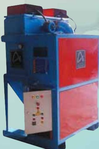
Вакуумный сборщик отработанного абразива (18 - 110 кВт)
