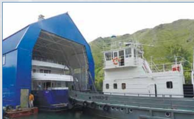
Буксир выводит СРТ «Байтерек» из стоечного судна-плавучего укрытия
