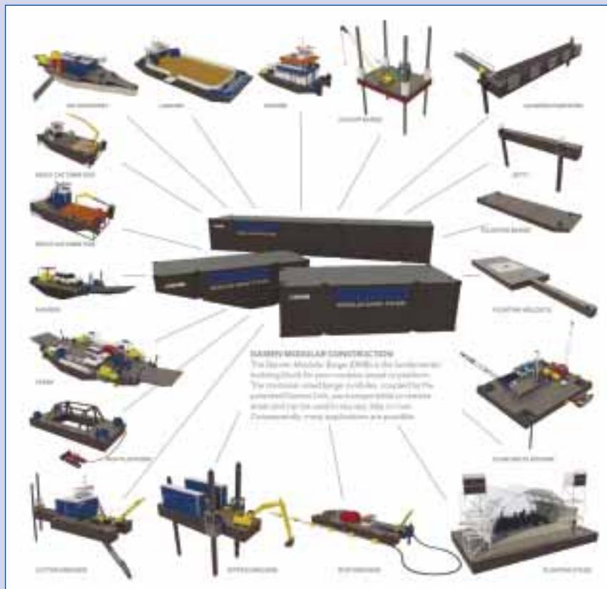
Номенклатура судов и плавсооружений, собранных из модульных барж Damen
