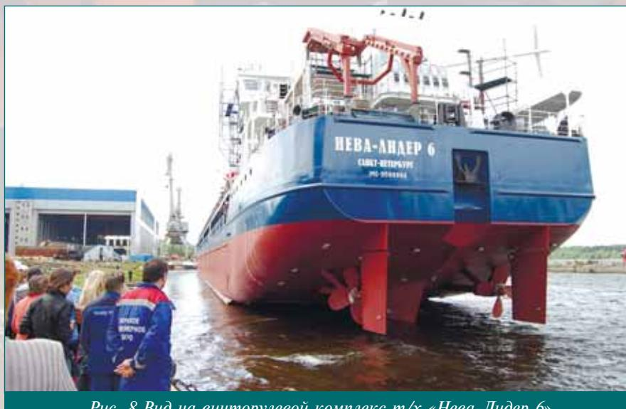
Рис. 8 Вид на винторулевой комплекс т/х «Нева-Лидер 6»
