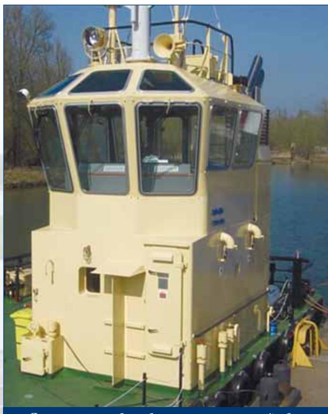
Двухъярусная рубка обеспечивает отличный обзор
