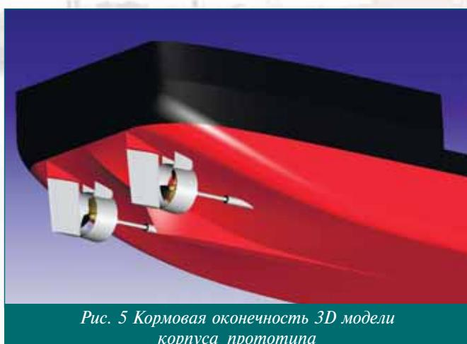
Рис. 5 Кормовая оконечность 3D модели корпуса прототипа
