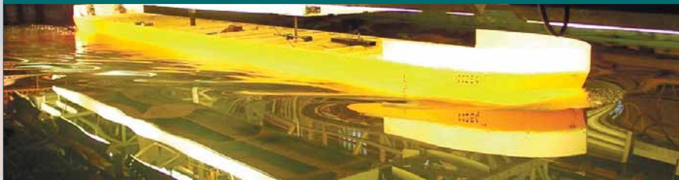
Следует отметить, что статистический метод, несмотря на тщательно подготовленную информацию о геометрических характеристиках корпуса, не обеспечил получения полного сопротивления судна с достаточной точностью. Использование же численного моделирования, напротив, дало возможность получить данные, близкие к результатам модельных испытаний.
