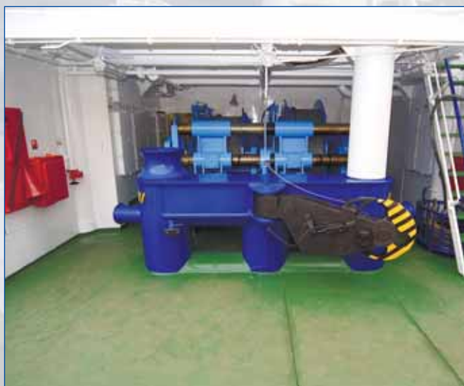
С «Панды» начали использовать ноу-хау «Краншип» - штиль, размещенный в одной из тумб кормового буксирного битенга
