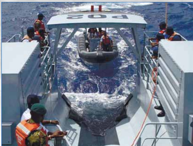
Кормовой слип и скоростные винты Damen Stan Patrol 4207
