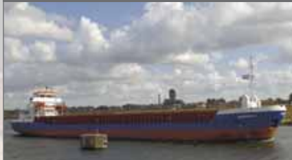
Сухогруз пр.3850. КССРЗ строит корпуса этих судов с высокой степенью насыщения. Достройка выполняется в Голландии.
