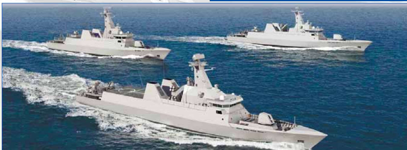
3-D модели трех корветов семейства Damen Compact SIGMA: Compact SIGMA 8011 (вариант без интегрированной мачты) и Compact SIGMA 6609. На заднем плане - Compact SIGMA 7310
