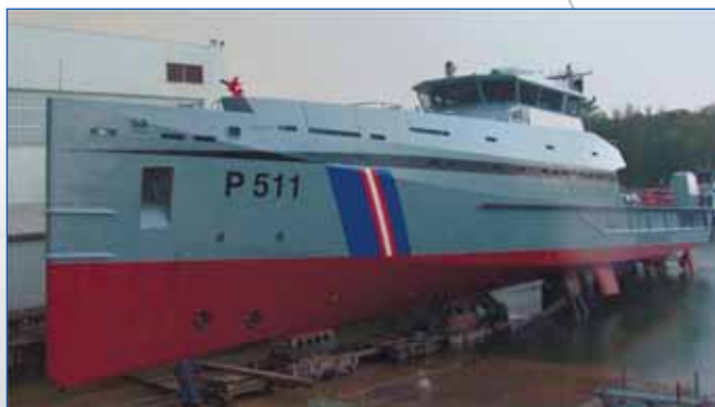
Damen Stan Patrol 5009 перед спуском на воду. Хорошо видны: нос типа «Ахе bow», подруливающие устройства, успокоитель качки и кормовой скег
