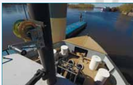
Бак судна: брашпиль и мощные кнехты
