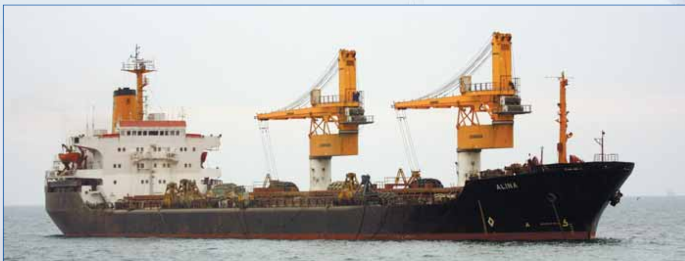
Балкер-перегрузатель «Alina» модернизирован для обеспечения перевалки и накопления навалочных грузов. По левому борту установлены два 30-тонных крана
