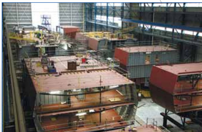
На Damen Schelde Naval Shipbuilding корабли семейства «SIGMA» собираются из стандартных модулей
