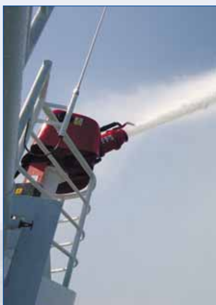
Пр. TUG60L оснащен системой пожаротушения на знак FF3WS
