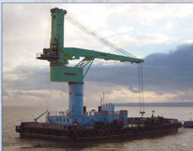
Несамостоятельный перегрузочный комплекс «Atlas 5» оснащен одним 30-тонным краном. Его длина 41,60 м, ширина 21,60 м, высота борта 4,00 м, осадка 1,82 м, водоизмещение 1518,0 т, дедевит 251,0 т.
