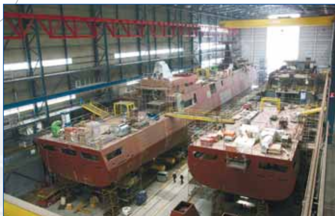
На Damen Schelde Naval Shipbuilding корабли семейства «SIGMA» собираются из стандартных модулей
