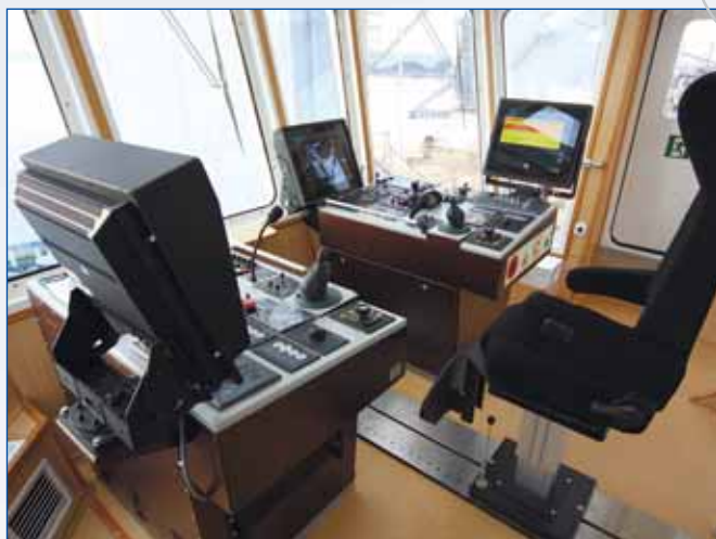
Сверхкомпактные мостиковые пульты «Панды»
