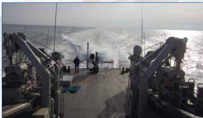
Кормовая палуба Damen Stan Patrol 5509. Скоростные катера размещены побортно
