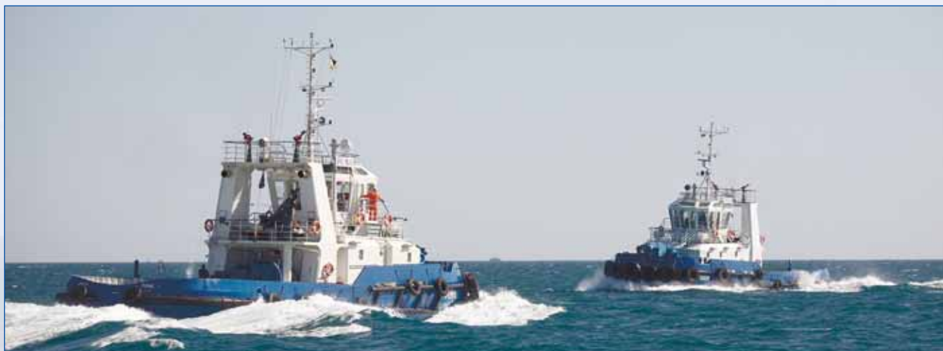
«Пума» и «Тайгер» - абсолютные близнецы. Отличие в одном - на «Пуме», кроме носовой, установлена и кормовая буксирная лебедка.
