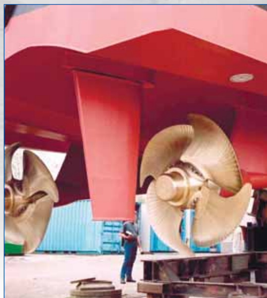
Кормовой слип и скоростные винты Damen Stan Patrol 4207
