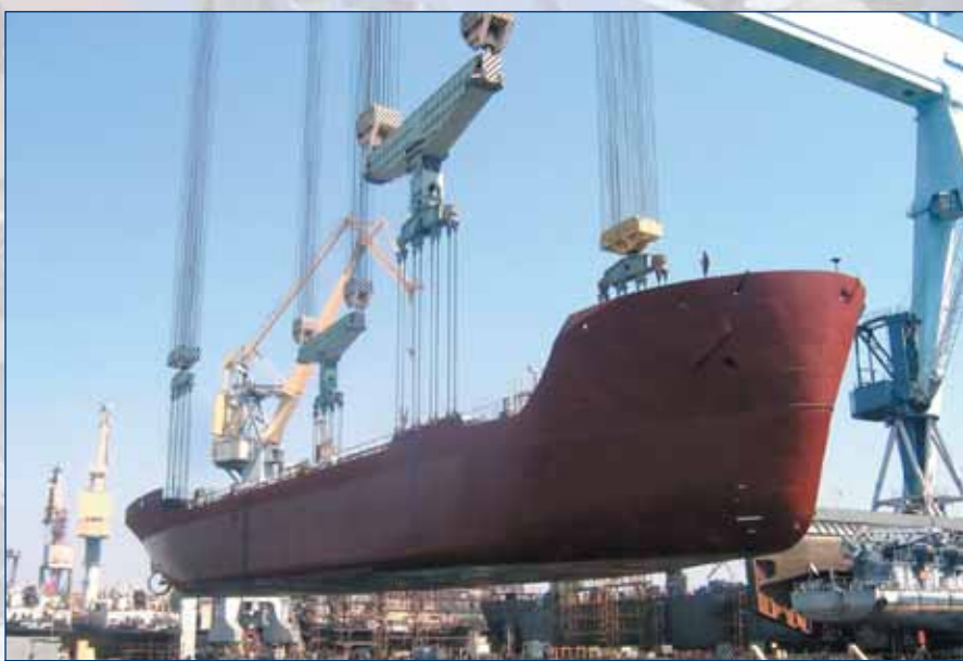
Для компании Aker Braila SA построены два корпуса танкеров, спущенных на воду с помощью установленных на 0-м стапеле «ЧСЗ» двух кранов грузоподъемностью по 900 тонн
