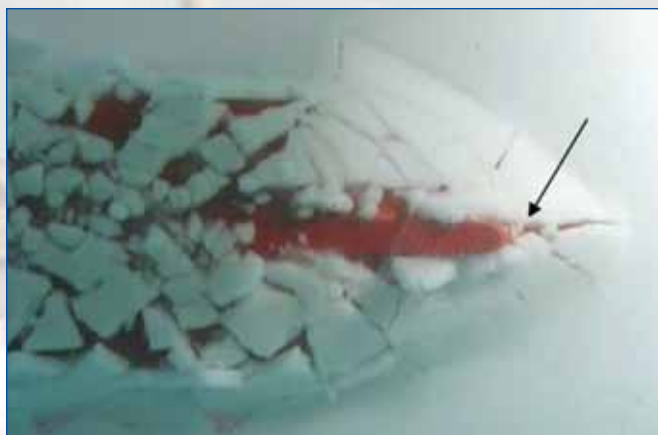
Фрагменты видеозаписей испытаний при толщине льда 0.50 м и 1.00 м
