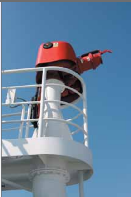
Испытания специальной пожарной системы буксира «Пантера» и лафетный ствол Unitor FFS1200/300 (внизу)
