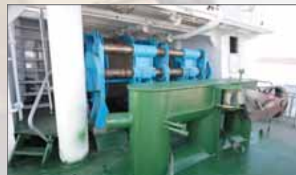
Кормовая двухбарабанная буксирная лебедка «Пантеры»
