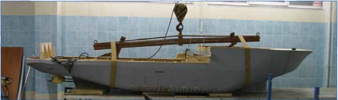
Общий вид большой модели для буксировочных и самоходных испытаний
