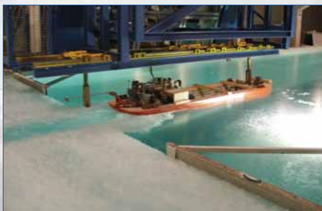
Фрагменты видеозаписей испытаний при толщине льда 0.50 м и 1.00 м
