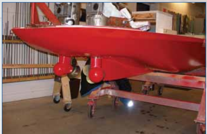
Модель, испытанная в ледовом бассейне фирмы Aker Arctic (вид с носа и кормы)
