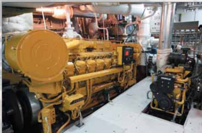
Машинное отделение «Пантеры»: вид на ГД и ДГ
