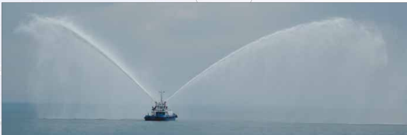
Испытания специальной пожарной системы буксира «Пантера» и лафетный ствол Unitor FFS1200/300 (внизу)
