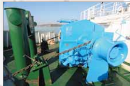
Носовая якорно-буксирно-швартовная эскортная лебедка производства фирмы Rolls-Royce
