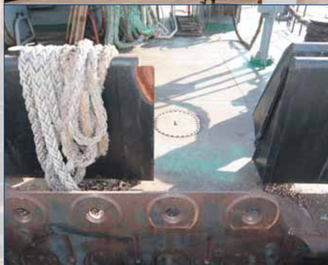
«Порт-Сервис» хорошо освоил методику спуска/подъема строящихся и ремонтируемых судов с помощью 900-тонных кранов «ЧСЗ». На этом плавкране компания стационарно установила сварные обуха
