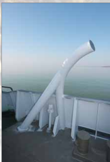
Бортовой ограничитель перемещения буксирного троса
