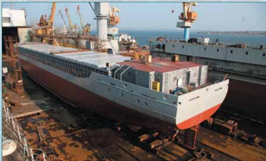
Корпус первого контейнеровоза для Damen Shipyards Bergum в передаточном доке завода
