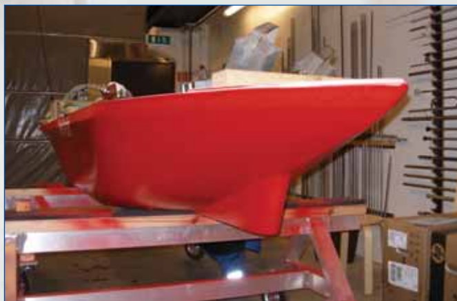
Модель, испытанная в ледовом бассейне фирмы Aker Arctic (вид с носа и кормы)
