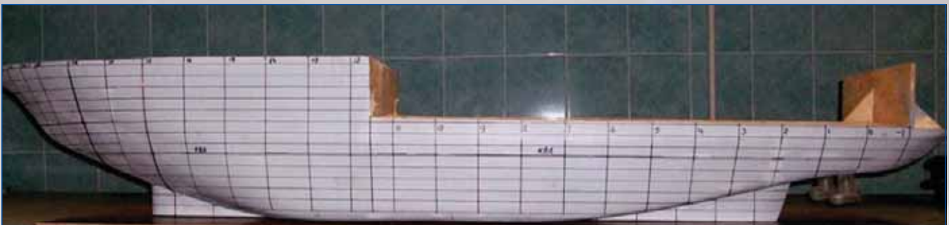
Общий вид малой модели для мореходных испытаний
