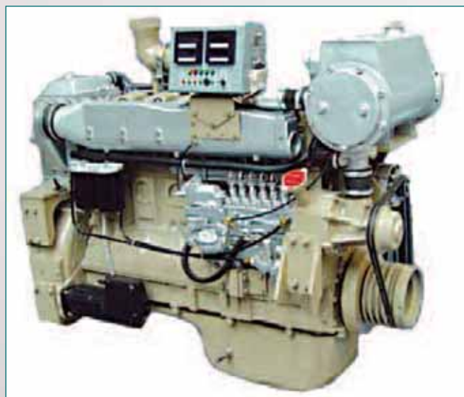
ВД618 мощностью 300 л.с., оснащенный реверс-редуктором типа 300, используется для замены дизелей ЗД12 при модернизации судов пр.869, 585, 1587
