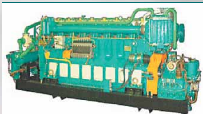
ДРРА48 может работать в паре с реверс-редукторными передачами типа GMC 36.39 (передаточное отношение 1,97), что позволяет сохранить прежние гребные винты судна
