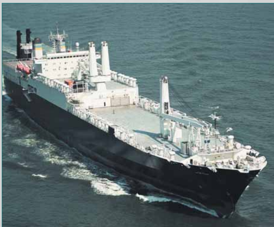
Газотурбинный ролкер пр.1609 «Капитан Смирнов» - прототип десантного вертолетоносца пр.10200 «Халзан»
