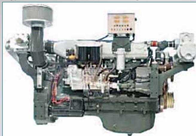
Энергетический комплекс в составе мотора ВД615 и реверс-редуктора типа 135А является хорошей альтернативой дизелям ЗД6
