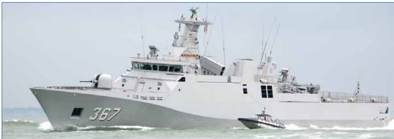
Корветы пр. SIGMA 9113 снабжаются скоростными катерами для обеспечения досмотра
