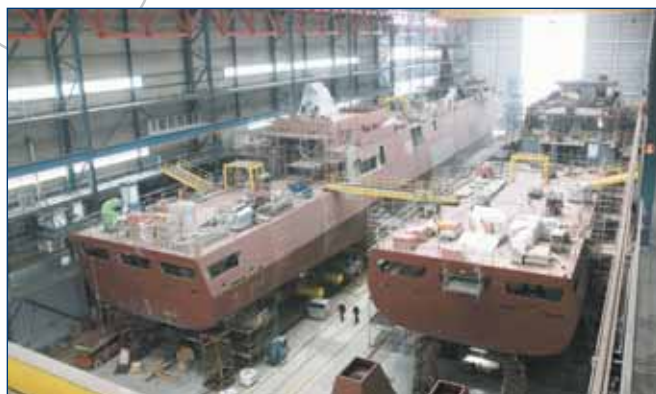
Идет сборка кораблей пр. SIGMA 10513
