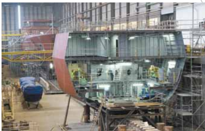
Из таких секций собирают корабли класса SIGMA
