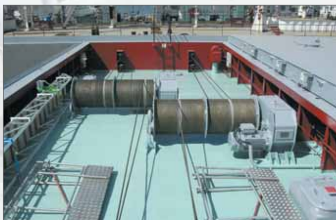
Лебедки люкового закрытия т/х «Капитан Рузманкин»
