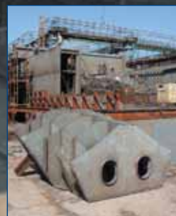
Корма танкера в кондукторе
