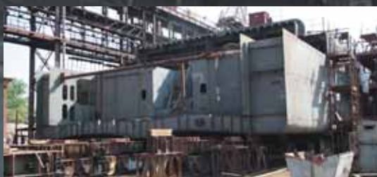
Формирование кормы первого танкера на стапеле
