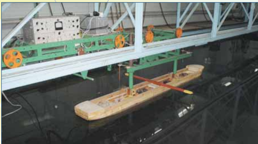
Идут испытания очередной модели, сделанной в мастерской гидродинамической лаборатории
