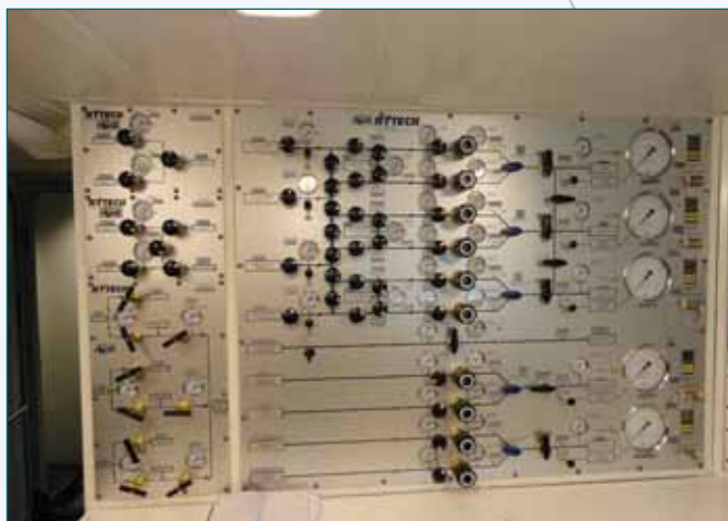
Интегрированный пульт управления, справа — консоль связи с водолазами
