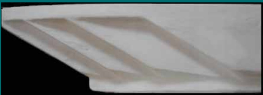
Упрощенный макет носовой оконечности ледокола (с меньшим количеством ступеней)
