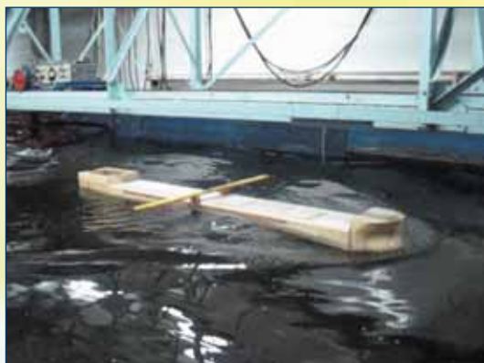
Испытания модели танкера пр. RST27 на волнении... и воплощение МИБ идеи в металле
