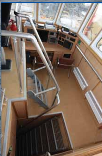
Первый ярус навигационной рубки буксира «Темрюк»: штурманский стол находится в стороне от прохода, что обеспечивает отличные условия работы судоводителей. Трап посредине ведет на второй ярус рубки, приподнятый за счет коффердама — там располагается главный пульт управления с отличным обзором.
