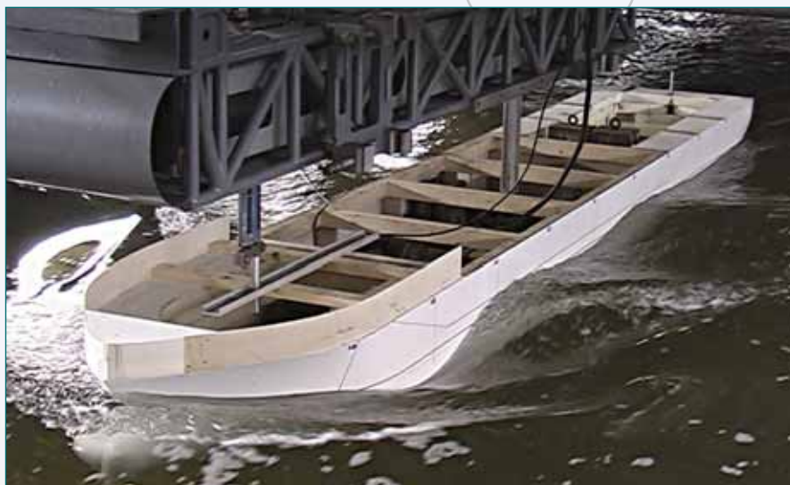
Испытания модели в опытовом бассейне Крыловского государственного научного центра с V_{\text{модели}} = 1,5 \text{ м/с} . Соответствует натуре V_s = 12 \text{ узлов}
