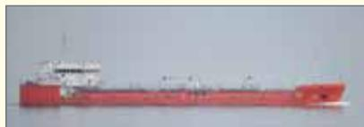
Танкер смешанного река-море плавания пр. RST25 дедвейтом в реке/в море 5220/6700 тонн
