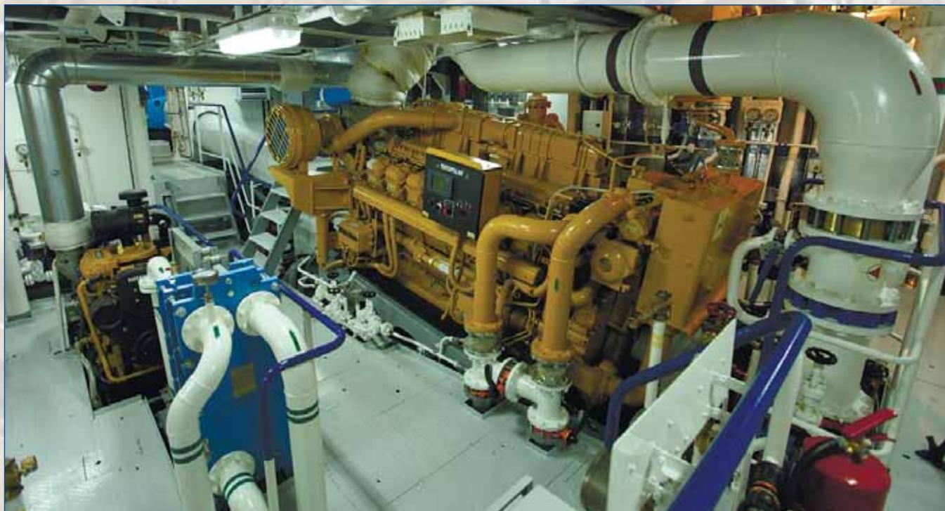
Энергетические установки буксиров ДП «Краншип» комплектуются дизелями Caterpillar
