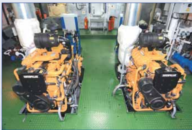
Вспомогательные дизель-генераторы Caterpillar C4.4 DIT
