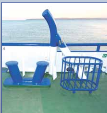
Бортовой ограничитель перемещения буксирного каната и корзина для швартовых
