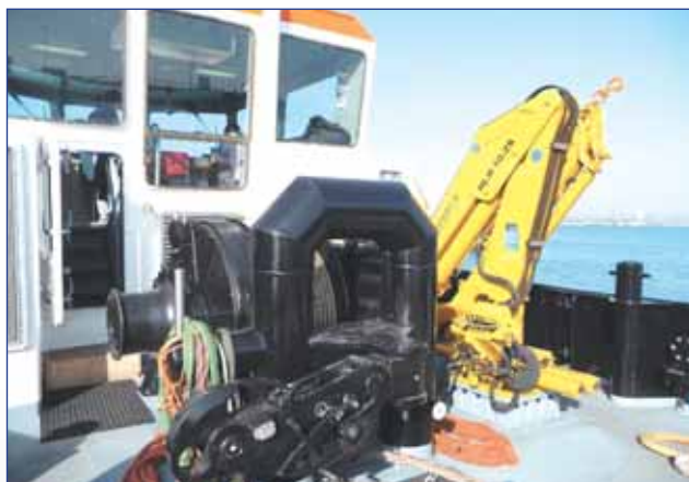
Кормовое буксирное устройство и гидравлический кран г/н 1 т
