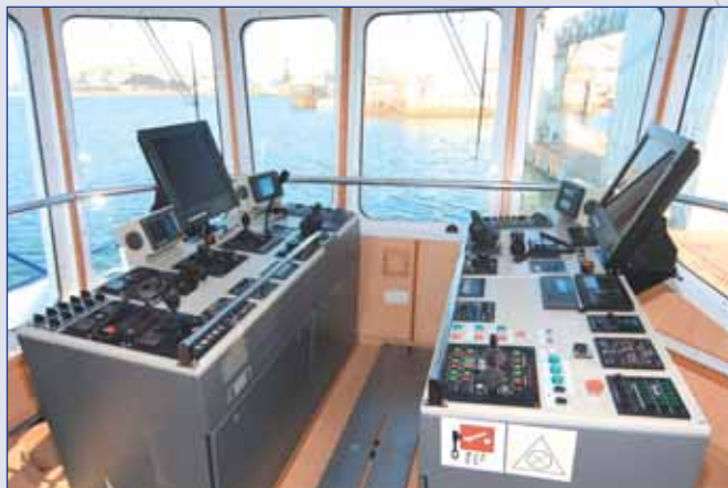
Пульт управления буксира пр. TUG60LA – максимальная комплектация
