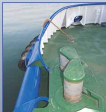
Кормовые подъемные ограничители перемещения буксирного каната («пальцы»)
